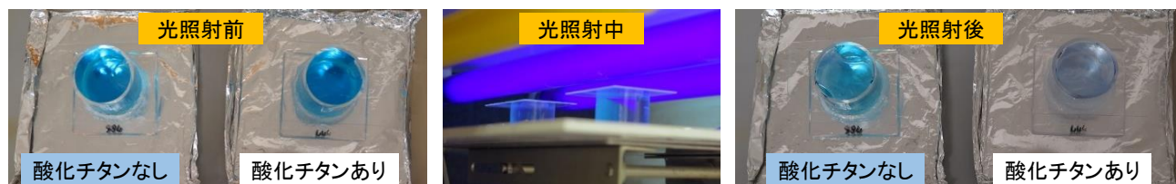
写真1 セルフクリーニング性能試験
