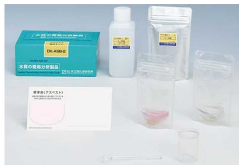
図1 アスベスト検出キット(製品名: DK-ASB-2)
