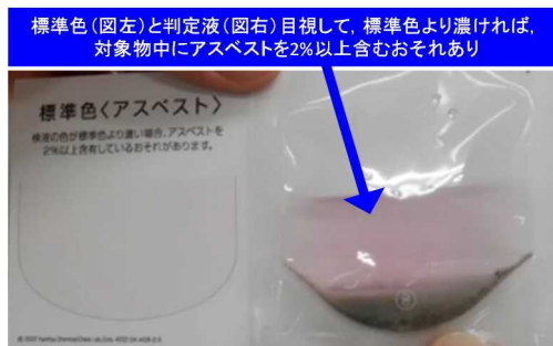
図2 アスベスト検出キットの判定方法
