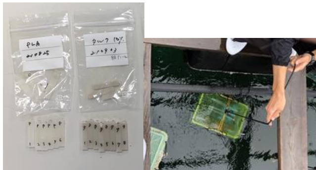
小型試験片と海洋浸漬の様子
