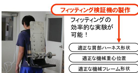
図3. フィッティング検証機による実験の効率化
