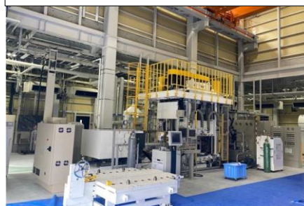
発泡装置付き縦型電動射出成形機
