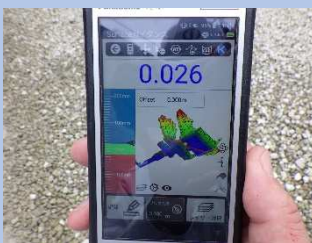
LandXMLデータの 測量機器への読込
