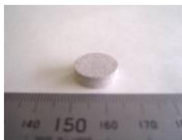
図4 作製したアルミニウム成形体
