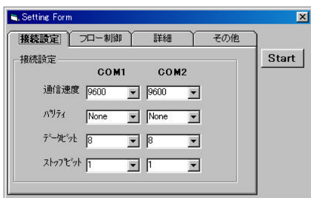
図 4 通信接続設定の一例
