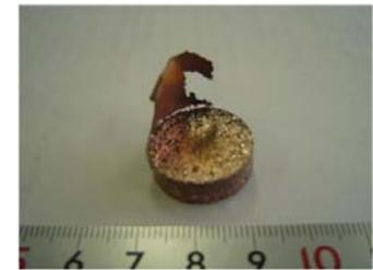
図2 作製したCu-60vol.%ダイヤモンド複合材の外観
