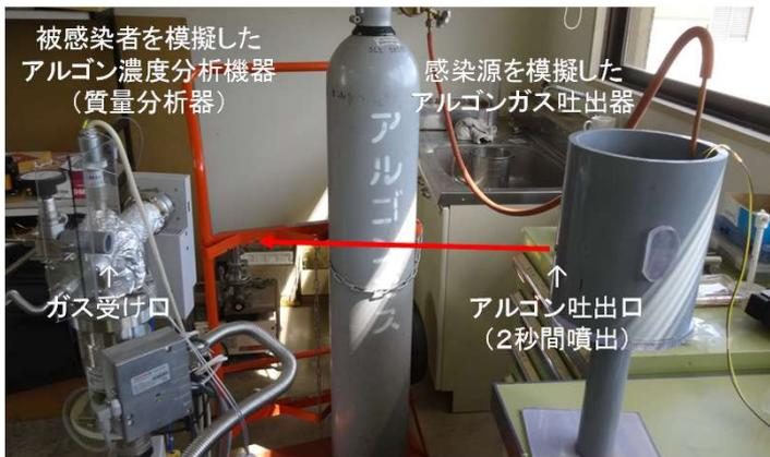
試作した空気感染評価装置
