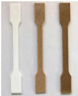
写真1 作製したダンベル試験片
