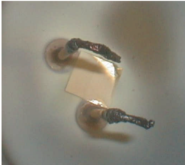
図5 電極近くのパーティクルの発生の様子 (40 Pa, TMS 1分、C 6 H 6 20分)
