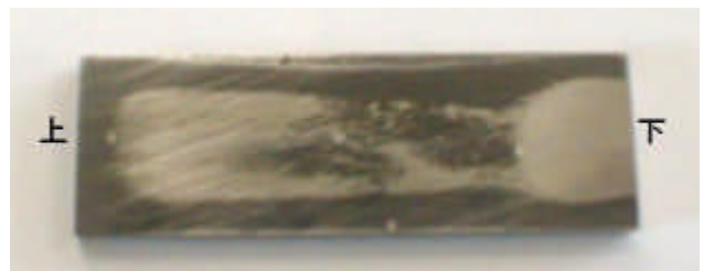
図4 板状基板に合成したDLCをサンドペーパーでこすりつけた後の膜
