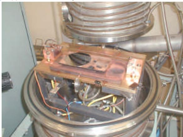
図4 試作した大面積基板合成用ユニット。4インチのシリコンウエハがのっている。
