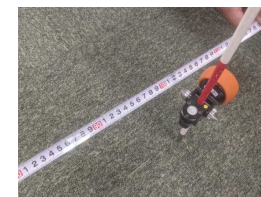
コンベックスを使用し 精度を確認
