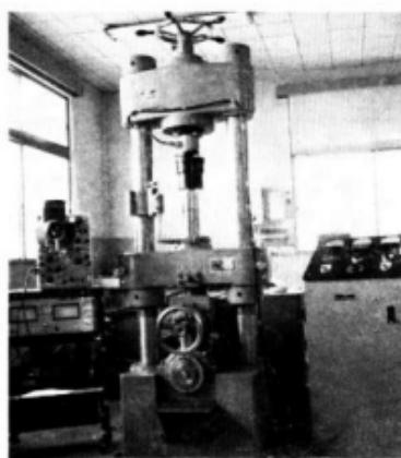
写真1 塑性加工変形抵抗試験機
