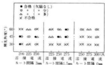
図5 JIS Z 3801による裏曲げ試験の判定結果
