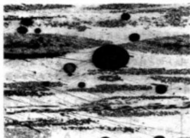
写真1. ハンドレイアップ法ハイブリッドCFRP断面
