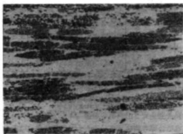
写真2. 熱プレス成形SMC断面( $\times 25$ )
