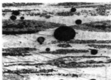
写真1. ハンドレイアップ法ハイブリッドCFRP断面( $\times 25$ )
