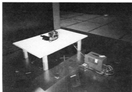
写真2 雑音端子電圧測定
