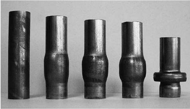
図9 二重管成形法による成形過程
