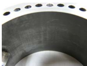
図4 耐久試験後のハウジング内面
