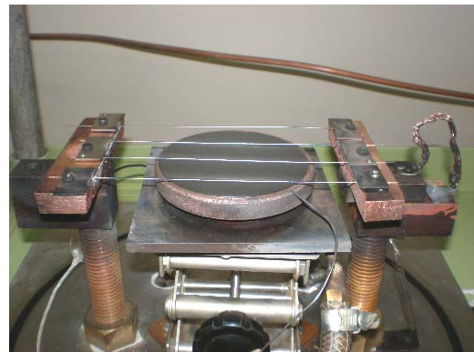
図4 電極部改造後の真空チャンバー内部
