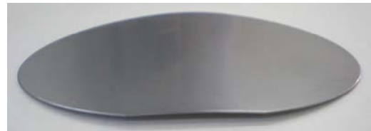
図3 熱により変形したSiウエハ
