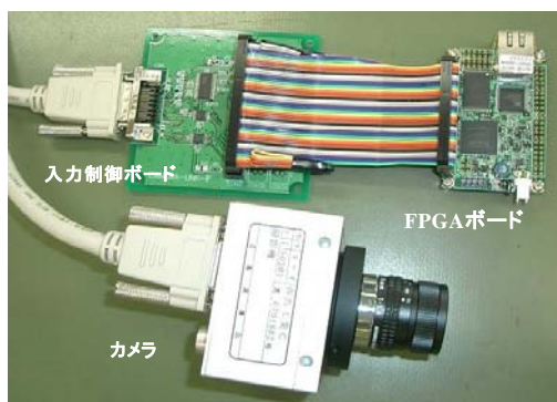
写真1 FPGA開発ボードのシステム構成の外観
