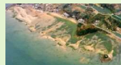
尾道糸崎港機織地区 浚渫工事で発生した 浚渫土を利用し 造成した人工干潟 (福田港海老地区)
