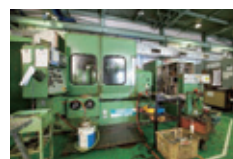
ライサワー製歯車研削盤を恒温室内に設置
