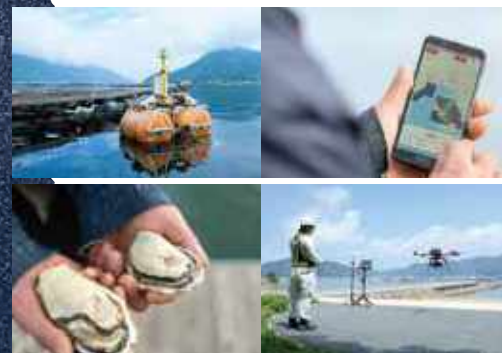
海に浮かぶブイに設置されたセンサーで取得された海洋情報をスマートフォンアプリでリアルタイムに確認できる。
