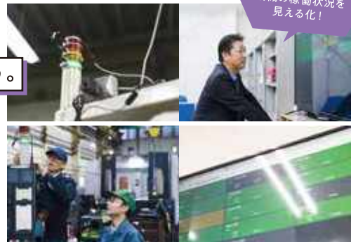
工場内の機械の稼働状況を知らせるランプをリアルタイムにモニタリングできる環境を整備して生産性の向上を狙う。
