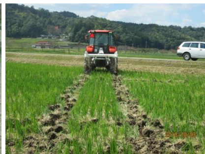
③ハーフソイラー施工
