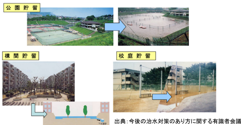
図 4.3.14 雨水貯留施設のイメージ
