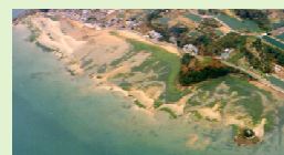
尾道系崎港機織地区 浚渫工事で発生した 浚渫土を利用し 造成した人工干潟 (福田海老地区)
