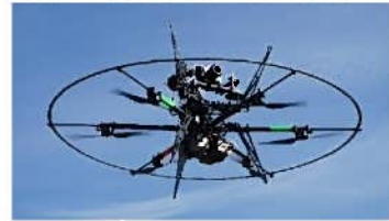
写真1：橋梁点検飛行状況
