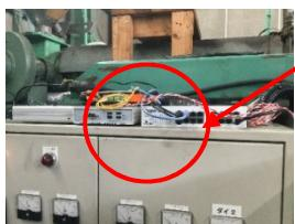
・左の写真のように IOT センサーを活用したデータを収集中ロボティクス化（自動化）することで、品質の向上と生産性向上を図る狙い
