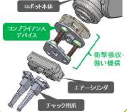
◆本機をロボットの先端に取り付けて、接触相手に倣って変形しつつ、衝撃を大幅緩和させます。
