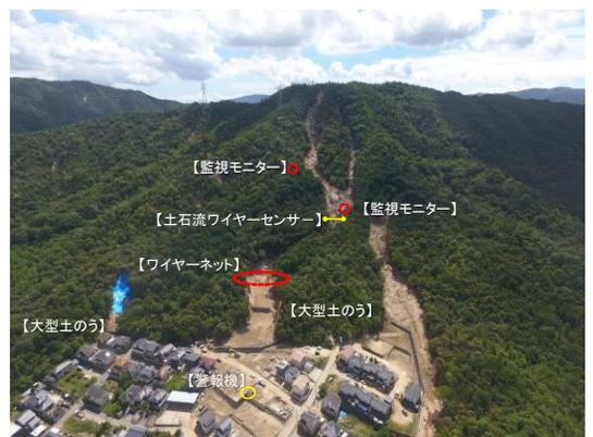
【東広島市 治山施設応急工事（大型土のう設置）】
