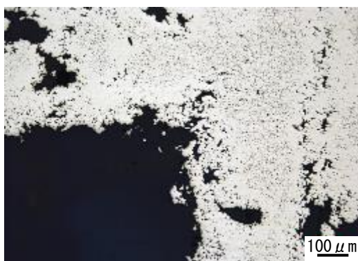
図8 3D造形焼結体のX-Y方向断面組織
