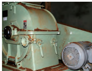
廃棄物を家畜の飼料に変え販売するための粉碎機の導入
