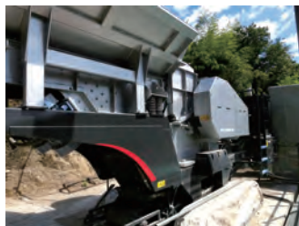
大量のがれき類などを破碎し再生砕石とする設備の導入
