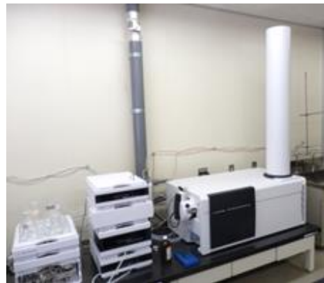
「無承認無許可医薬品」の分析に使用している Agilent Technologies 社製 6540 LC-QToF/MS
