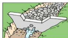
土石流発生後／中小洪水で土砂を少しずつ下流に流します。
