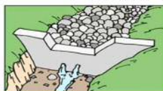
土石流発生時／ためた土砂の上にさらに土砂がたまります。
