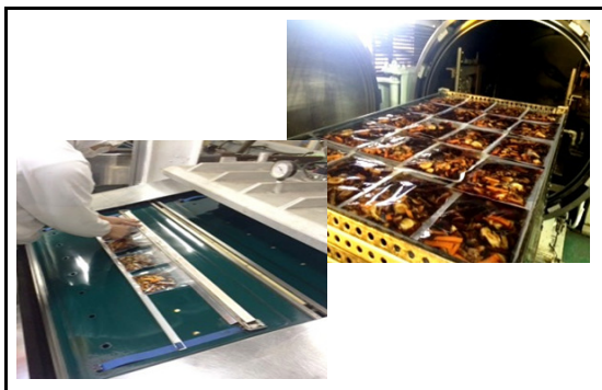
左真空処理、右加圧加熱殺菌処理
