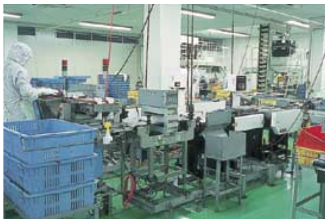
カットされたスティックタイプのサラミの計量・選別・袋詰めまで一に行う機械
