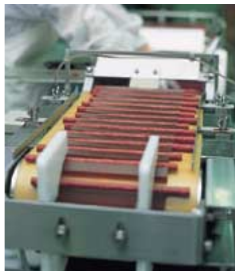
サラミ供給機。一本一本を均等な間隔でコンピュータ計量器へと送り込みます
