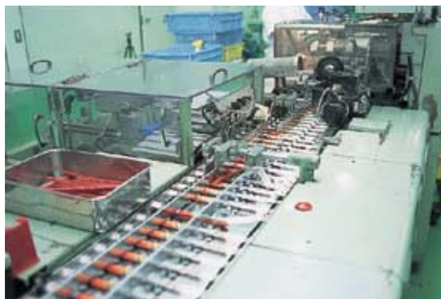
サラミソーセージと脱酸素材が封入され、機械から出てきた完成状態の製品。封入が不完全だった場合もコンベアが停止し、ランプが点灯します
