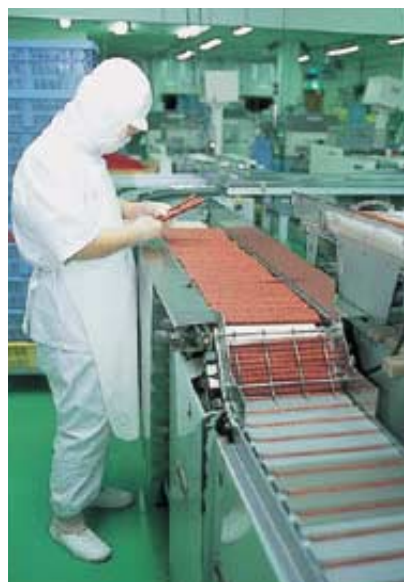
キャタピラセパレータ。適格・不的確を機械が瞬時に判断して選別するため、この位置では障害者一人で管理することが容易になりました
