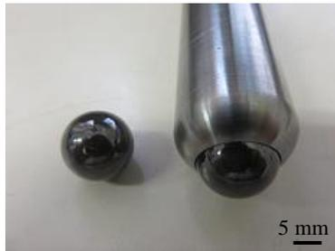
図2 窒化珪素球と摩擦アンカー
