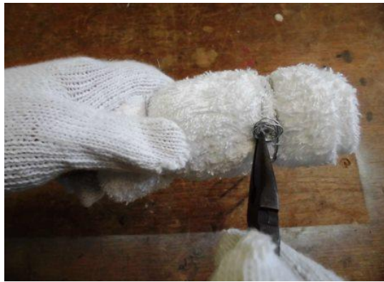
④ 針金で2か所を止める。針金はペンチを使用して しっかりねじりながら締めていく。
