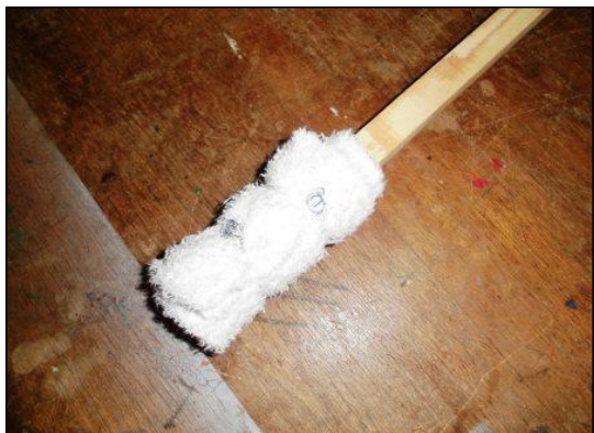
⑤ 針金の先端は危険なので、写真のように丸め、 タオルの中に隠すようにする。
