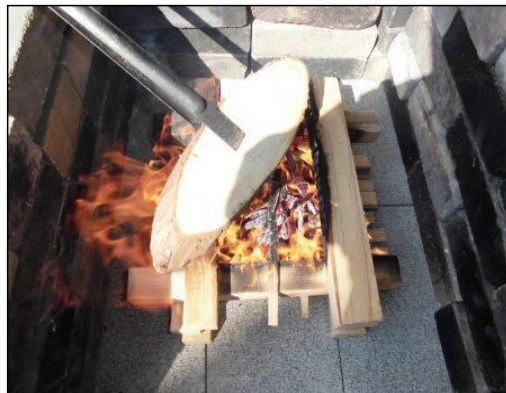
① 火ばさみを使い、火で板の表裏を平均して焼く。 ※ やけどに注意。 ※ 急激に強く焼くと割れやすい。
