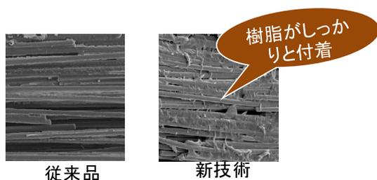
図1 破断面の拡大写真
