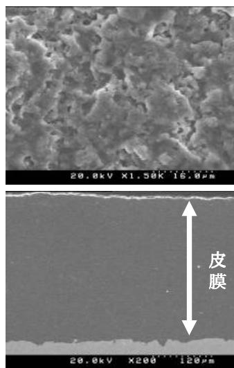
図1 酸化アルミニウム溶射皮膜
