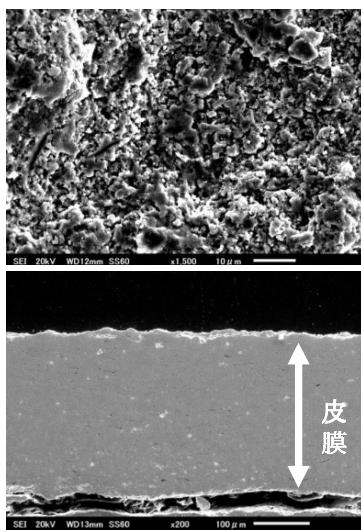
図2 酸化ジルコニウム溶射皮膜
