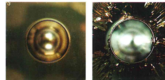
40A-500V 40A-0V 〔イオン化電極電流が40Aの場合，基板電圧が低いと剥離するが，基板電圧が500Vでは剥離が見られない〕 エリクセン試験結果の外観（直径22mm）
