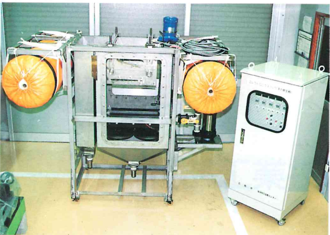
有機汚泥一次濃縮装置
