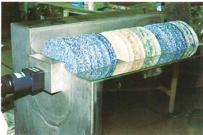
排水処理装置とリサイクル接触回転円板
