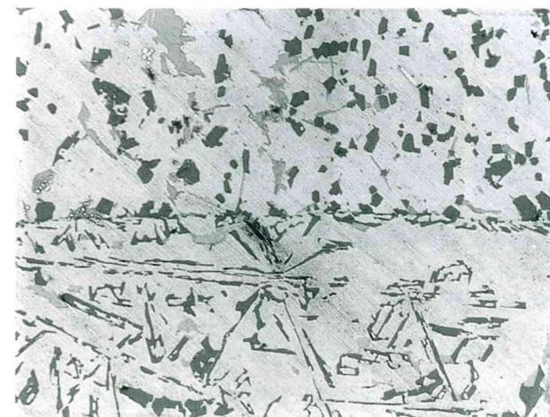
一体複合化した複合材料／アルミニウム合金部材の接合界面組織
