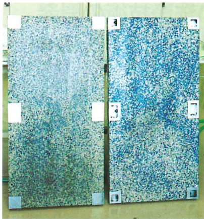
補強筋入り組立型コンクリート型枠
