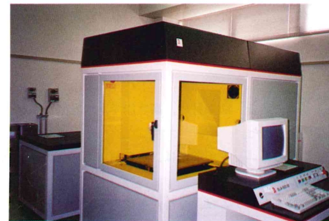
写真3：当センターに導入された光造形装置と試作例
