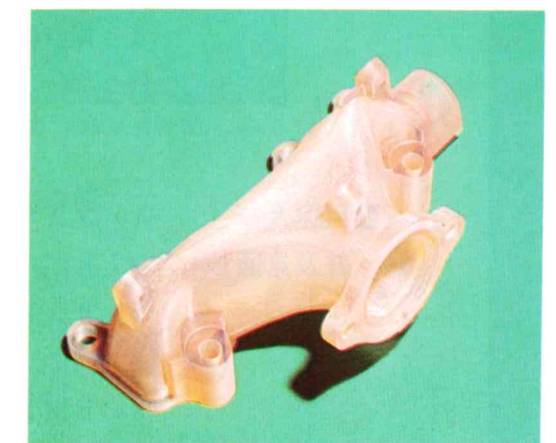
写真3：当センターに導入された光造形装置と試作例
