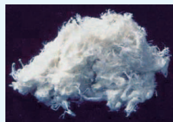
白石綿 (クリソタイル)
