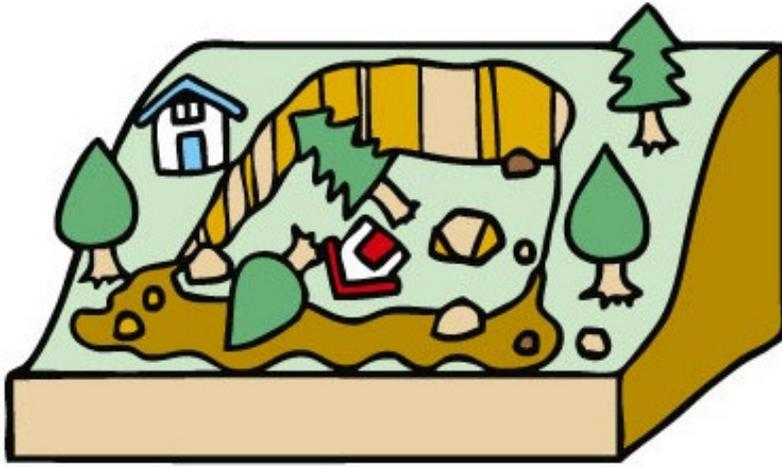
É o movimento do solo decorrente de infiltração de chuvas em solos argilosos e outros solos de pequenas encostas vulneráveis ao deslizamento.
