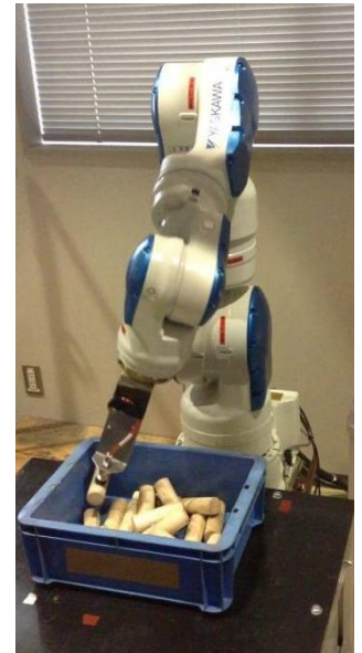
開発技術で積み木を ランダムピッキング するロボット
