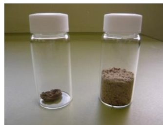
自然乾燥したリグノCNF(左)と真空凍結乾燥したリグノCNF(右)
