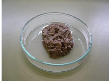
水熱処理によって作られた リグノCNF 水 約90% 固形分約10%
