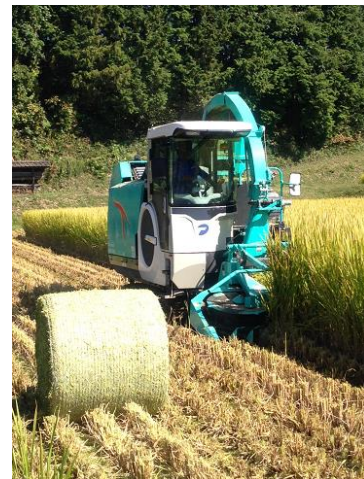
『たちすずか』を収穫する試作ヘッダ搭載微細断収穫機
