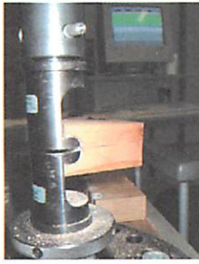
写真1 JIS割裂抵抗試験
