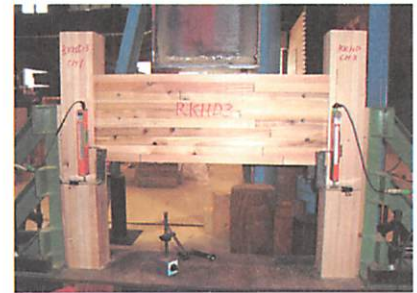
写真3 柱・梁せん断試験
