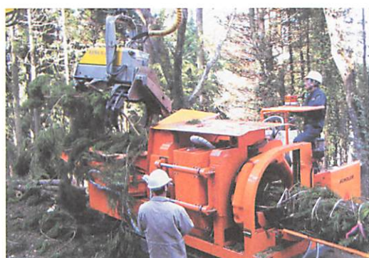
バンドリングマシンによる連続バンドル作業
